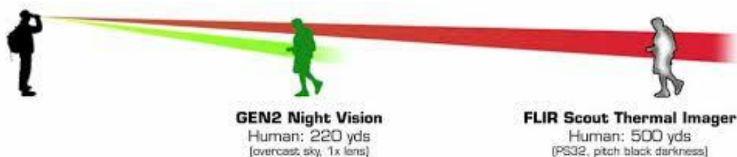
Abb. 10: Unterschied der Reichweite eines Röhrengerätes zur Wärmebildkamera
